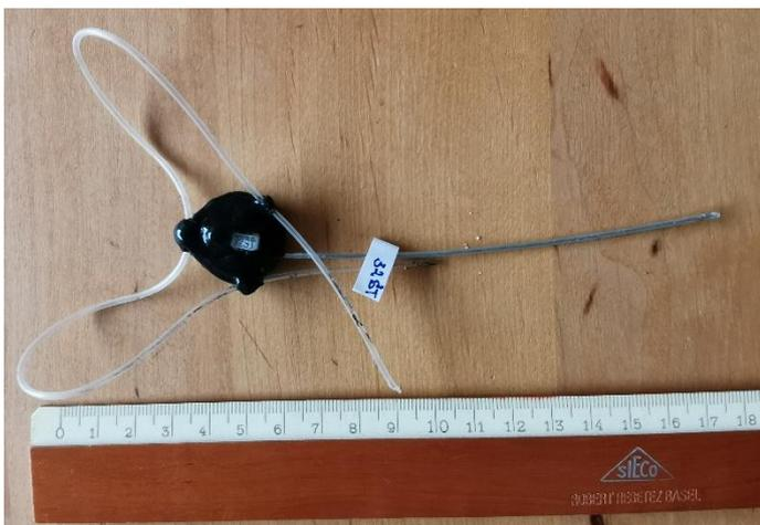
**Abb. 4** Telemetriesender (Nummer 32ST), wie er im Projekt eingesetzt wird. Die beiden Schlingen werden um die Beine gelegt, so dass der Sender auf dem Rücken der Eule zu liegen kommt.
